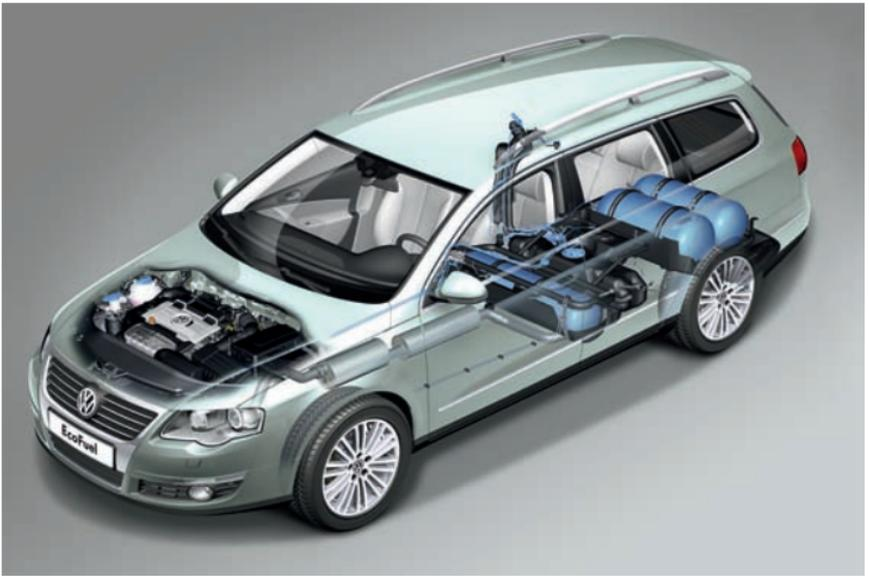
Durchaus imponierend ist auch die maximale Reichweite: Mit 21 kg Gas, das in drei Tanks unter dem Fahrzeugboden lagert, sowie 31 l Benzin fährt der Passat 1.4 TSI EcoFuel über 900 km\* weit. Allein der Erdgasvorrat reicht dabei für 480 km\*.
